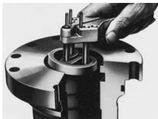
FIGURA 13. Útil de montaje 1 para juntas de vástago.
