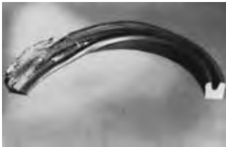
FIGURA 7. Junta destruida por la formación de presiones hidrodinámicas
