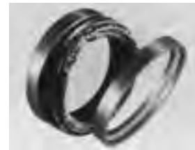
FIGURA 12. Rotura por extrusión de una junta compacta de émbolo
