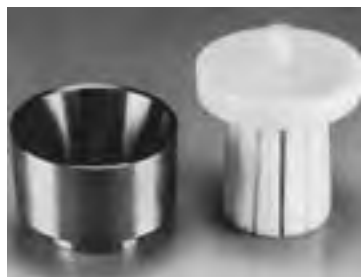
FIGURA 16. Útil de montaje para juntas de vástago
