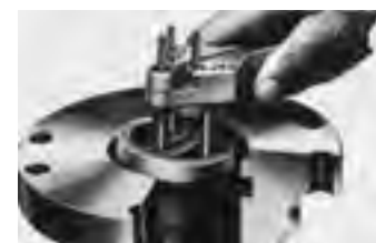
FIGURA 15. Útil de montaje 1 para juntas de vástago
