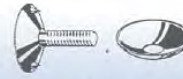
DIN 15237 Tornillos de platillo con prisioneros y arandelas de platillo con prisioneros
