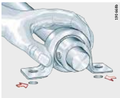
Figura 19 Deslizar el soporte sobre el eje
