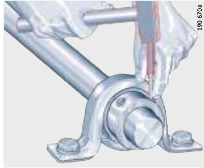
Figura 21 Apretar el anillo tensor excéntrico
